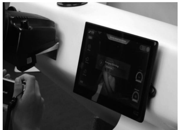
図8 運転中に飲み物などを取ろうとして視線がズレると警告が表示されるシステム。
