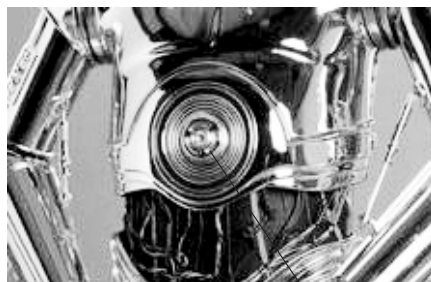
充電コンセント
