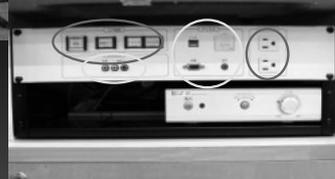
ICTボックス(右)前面には電子黒板等の電源スイッチ、コンセント、接続端子(RGB, AV, USB, 音声, 校内LAN)がまとめられている
