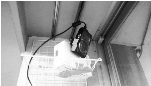
図10 定点カメラの設置方法
